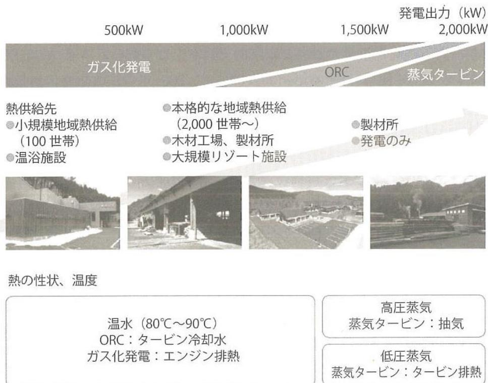
図 3-2 発電方式別の出力等導入規模、利用用途、得られるエネルギー
