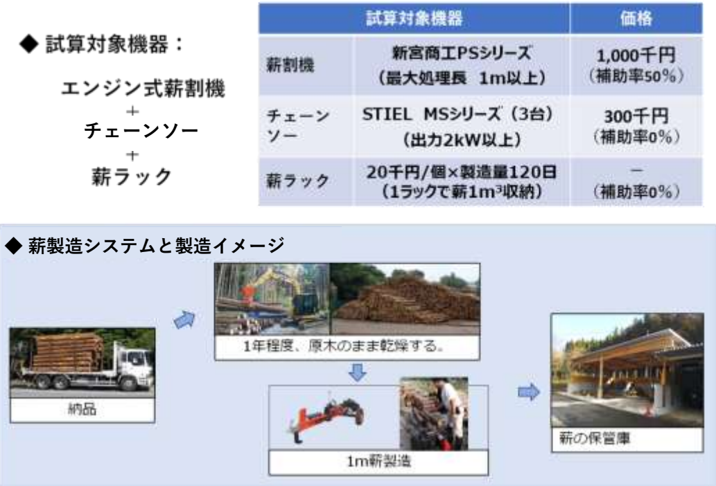
図 4-15 導入を検討するシステム（1m薪割機）
