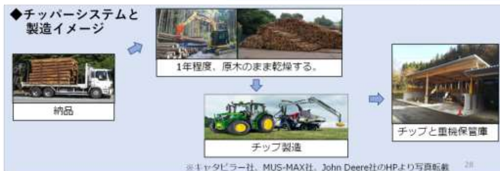
図 4-14 導入を検討するシステム（大径木対応チップー）
