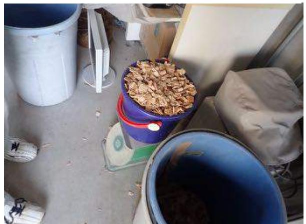
写真 4-4 チップの重量測定
