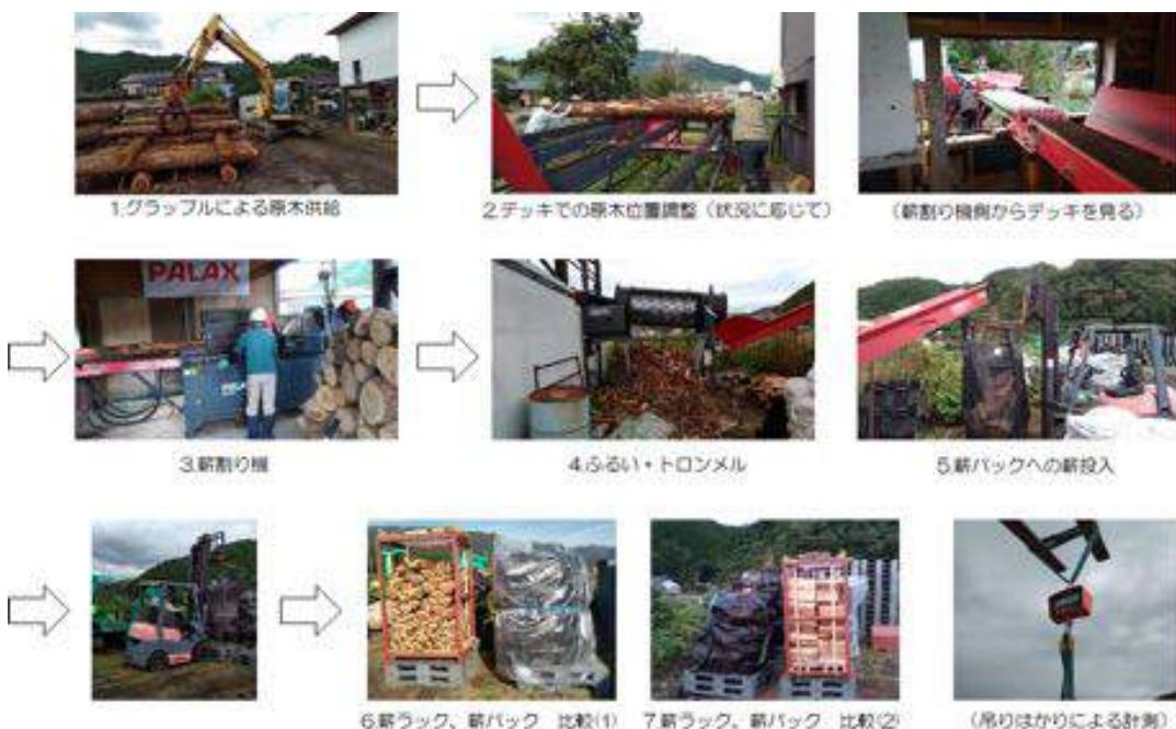
**図 4-11 自動薪割り機による薪製造試験の流れ**
