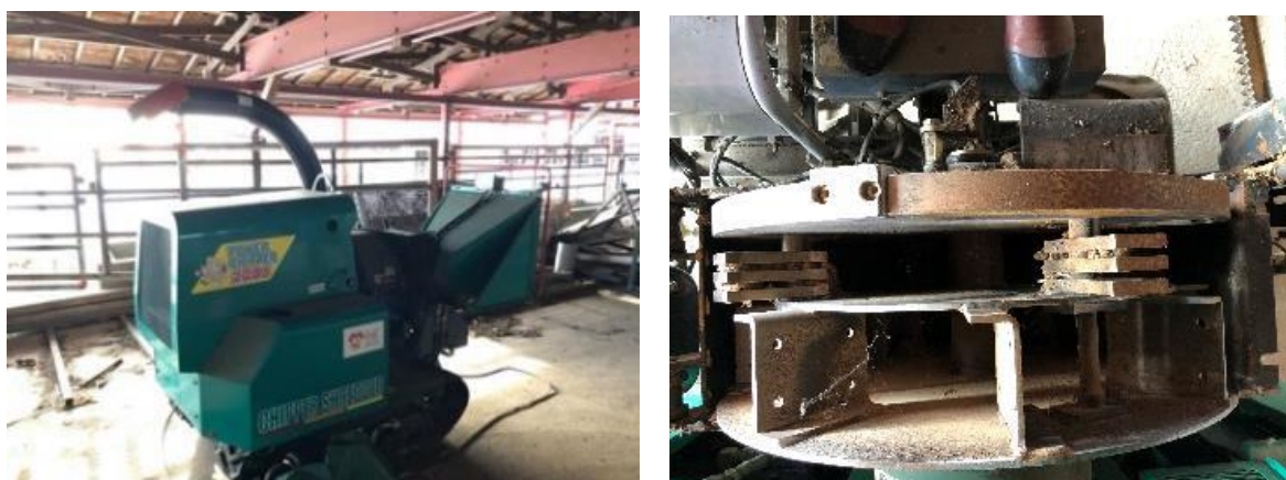
図 3-15 既存チップパー外観（左）と内部構造（右）
