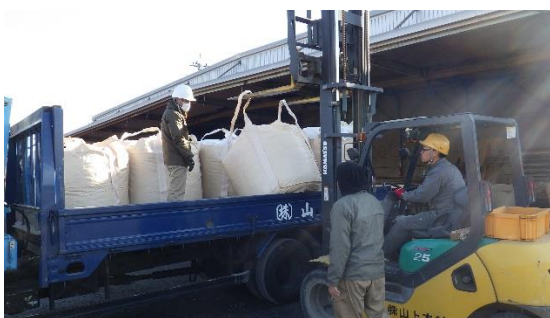
写真 3-11 フレコンバッグ積み込み
