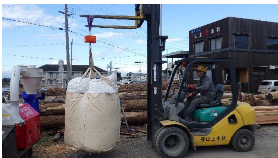
写真 3-9 フレコンバッグ重量計測
