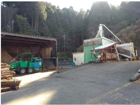
写真 3-16 破砕チッパー（左）とチップ乾燥キルン炉（右） 写真 3-17 反対側の写真 切削チップ置き場
