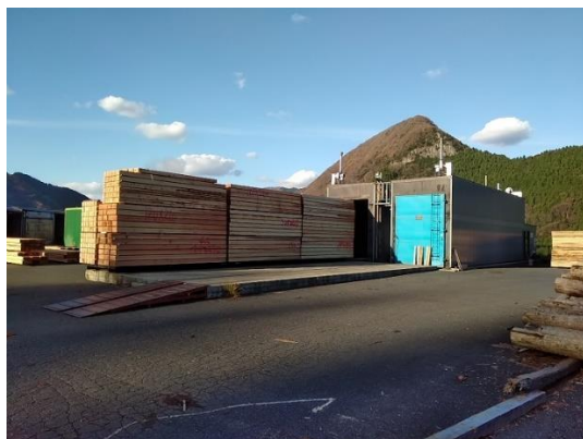
写真 3-5 高温乾燥機と製品
