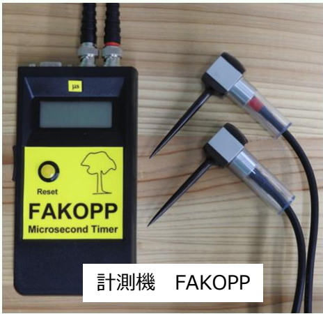
図 3-3 丸太の乾燥調査方法（出典：鳥取県林業試験場作成資料）
