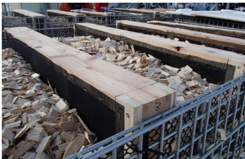
写真 6-3 スリットを施工したコンテナ
