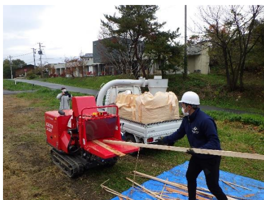
移動式小型チップパーによるチップ製造試験
