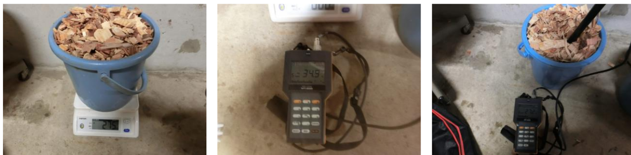
図 3-6 冬期 役場庁舎 水分計での測定の様子
