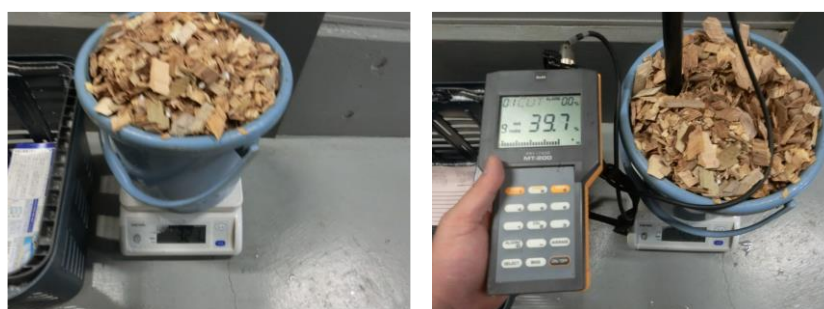
図 3-7 冬期 小国小学校 水分計での測定の様子
