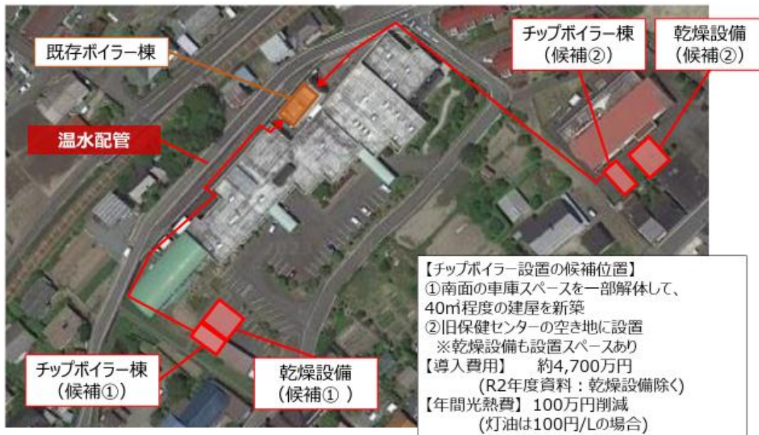
図 3-12 高齢者福祉施設でのチップボイラー・乾燥設備の設置候補
