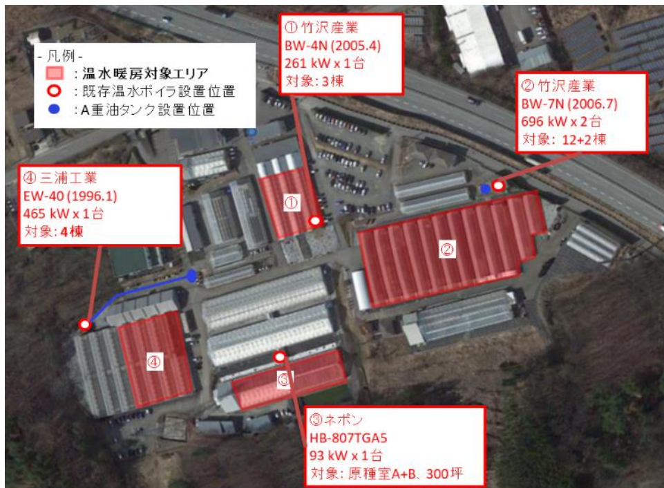
図 3-14 温水配管暖房設備導入済みのハウス
