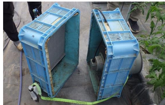
写真 3-14 自作の温風発生器
