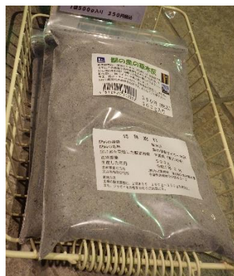
写真 3-12 燃焼灰を活用した土壌改良材
