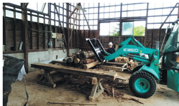
薪製造ラインとホイールローダー 出典 西目屋薪エネルギー株式会社
