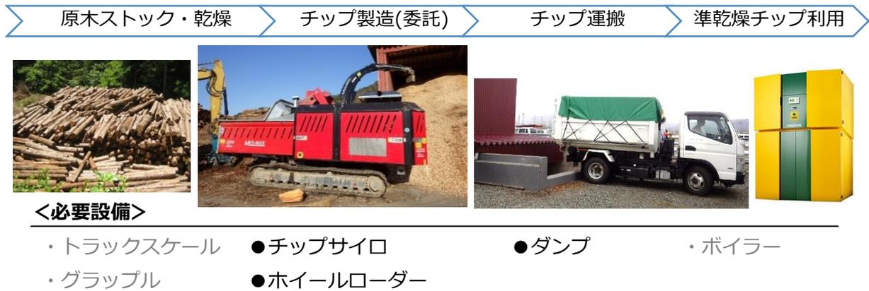
図 5-7 委託製造（切削、移動式チップパー）の流れ及び必要な機器設備
