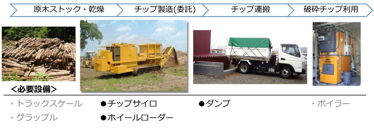
図 5-8 委託製造（破碎、移動式チップパー）の流れ及び必要な機器設備
