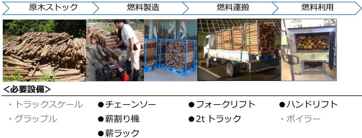
図 5-4 製造の流れ及び必要な機器設備
