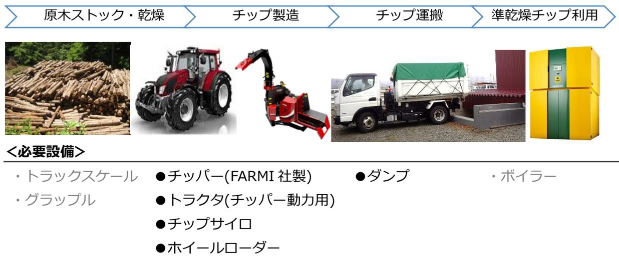
図 5-6 新規製造（切削、移動式チップパー）の流れ及び必要な機器設備
