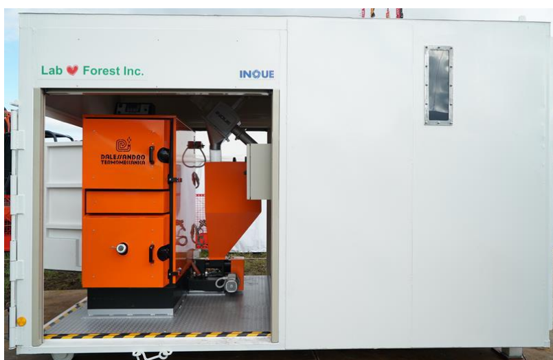
図 3-14 ボイラーのコンテナ格納 (ラブ・フォレスト㈱資料より引用)
