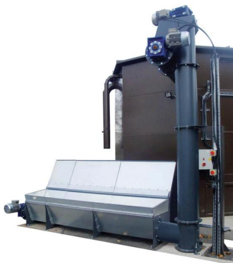
図 3-15 チップの垂直搬送装置
