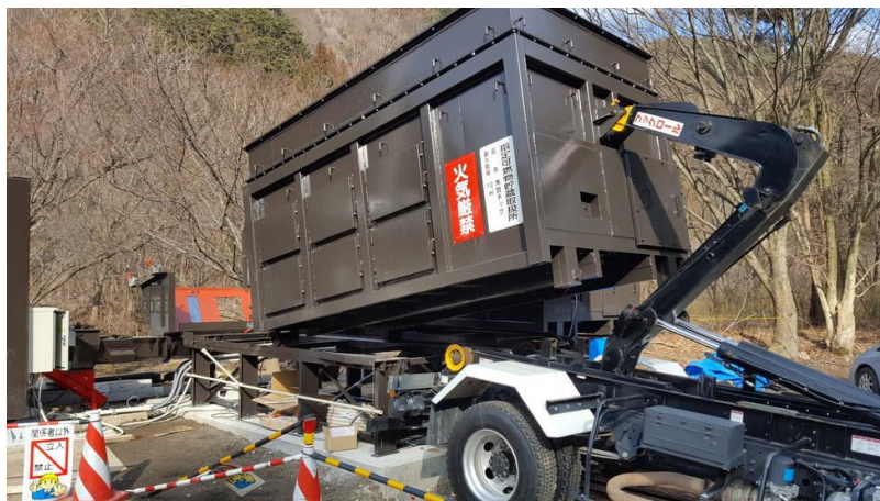
図 3-16 コンテナ着脱方式 (ラブ・フォレスト㈱資料より引用)
