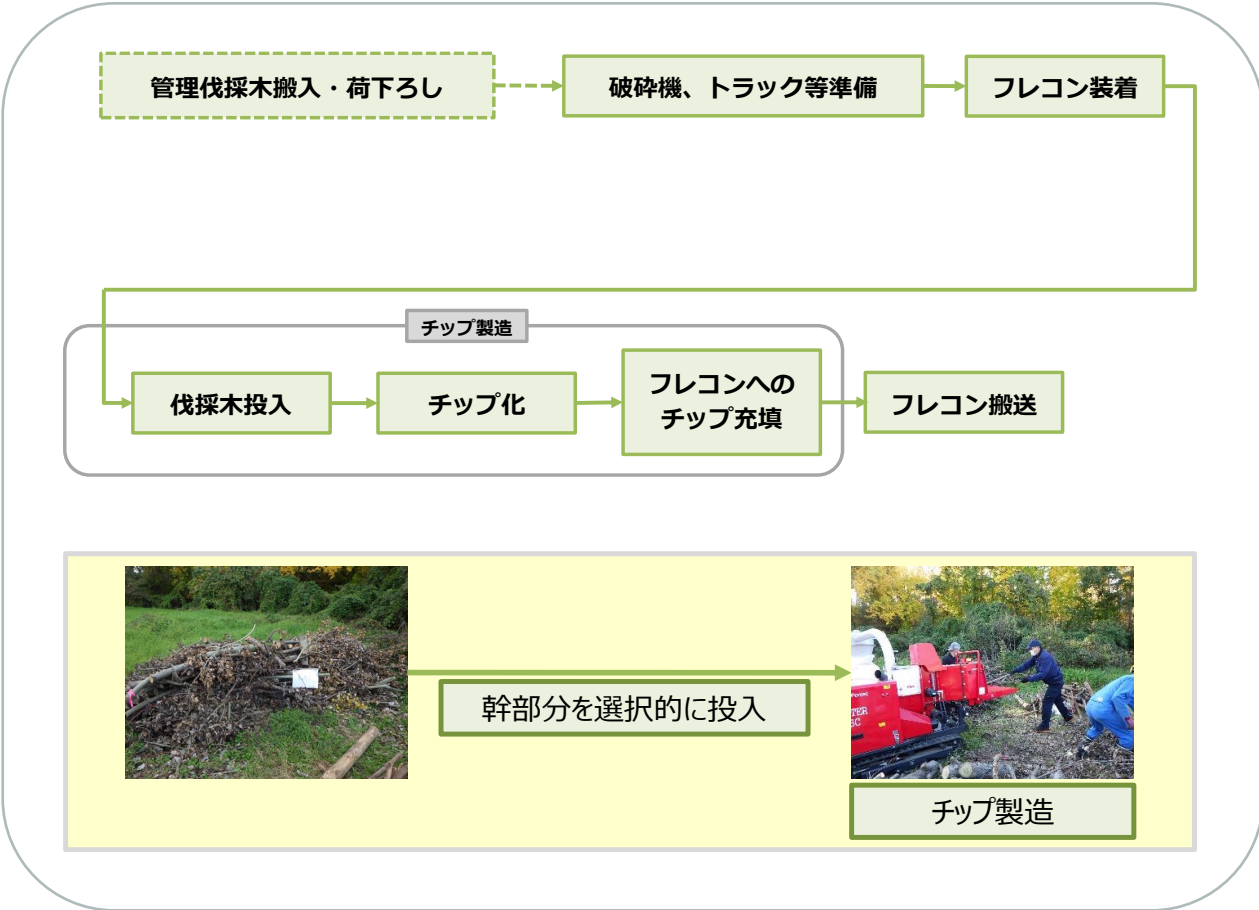
図 3-10 針葉樹、針広混交ロットの作業工程
