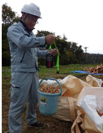
写真 3-31 チップのかさ密度計測
