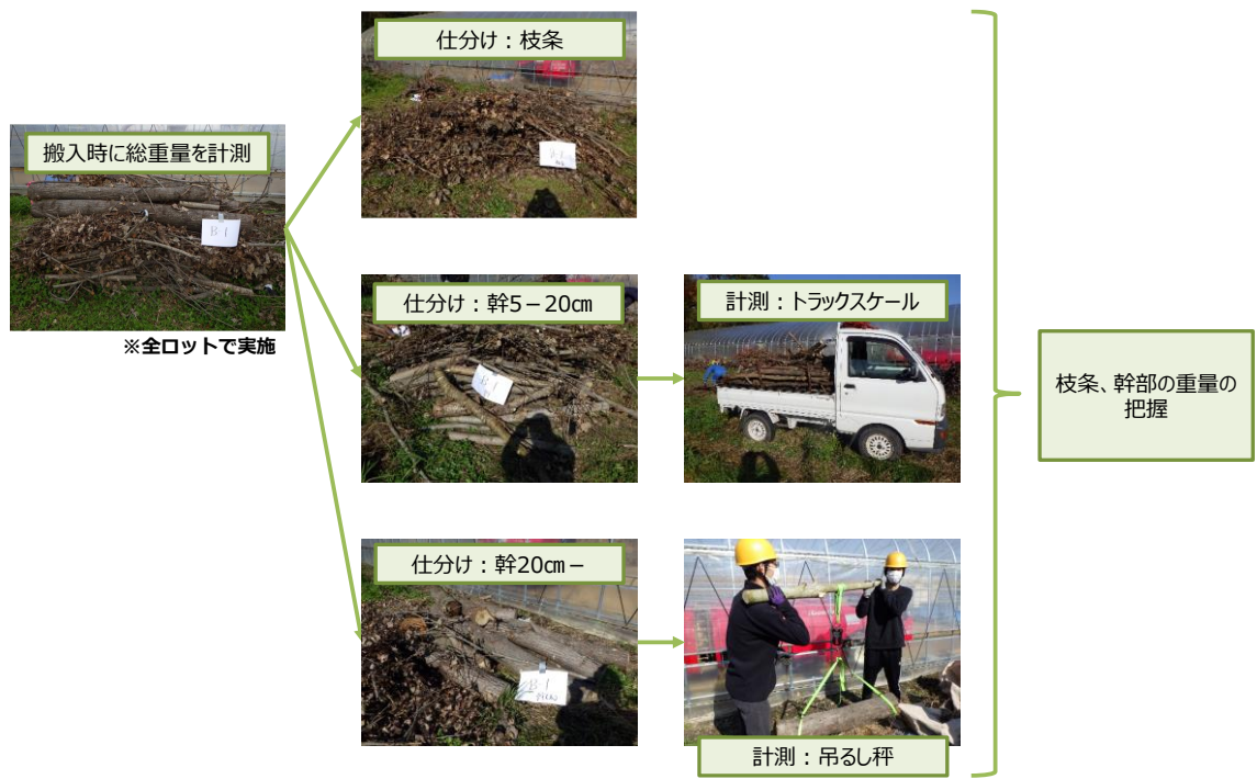
図 3-9 ロットの重量計測方法
