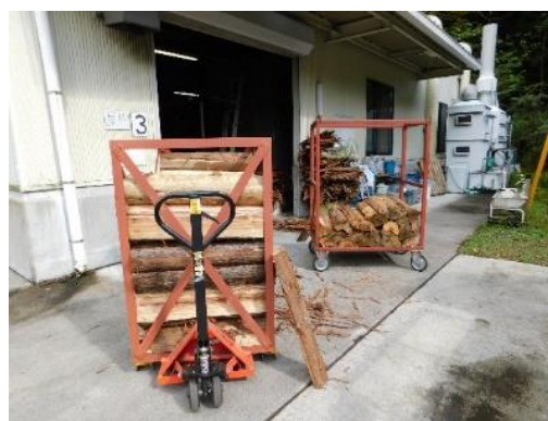
手前の薪ラックはハンドリフトで移動 適宜、車輪付ラックに積替えている
