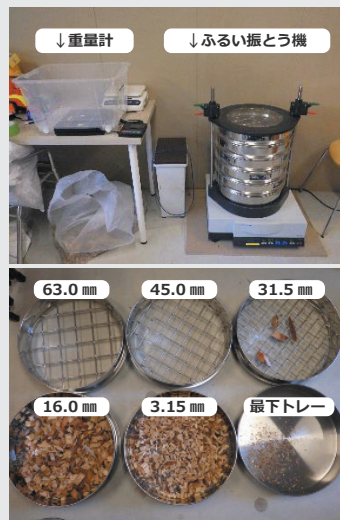
試験例：ふるいによる粒度の測定
