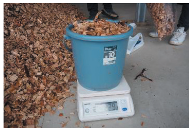
チップ品質試験 サンプル回収の様子
